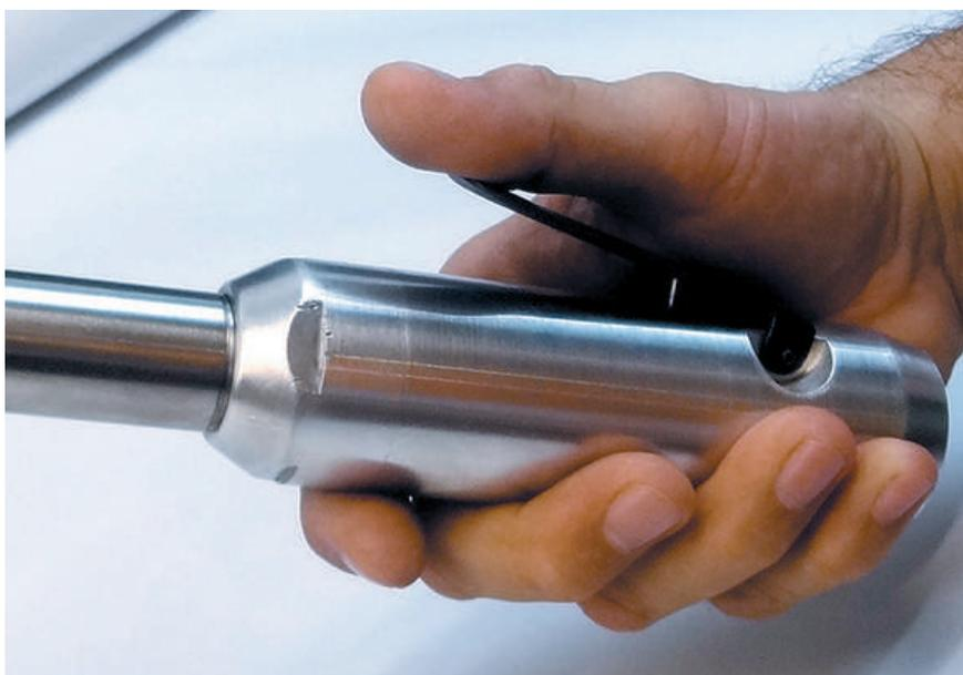
Detalhe da válvula de controle de acionamento rápido instalada na mangueira para controle do operador. Em caso de acidente, ocorre o seu fechamento instantâneo para evitar o chicoteamento da mangueira.
