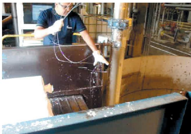
Na retirada do arame, o risco permanece pela sua rigidez, resistindo a flexão, podendo escapar da mão do trabalhador e feri-lo com a ponta afiada da extremidade cortada.
