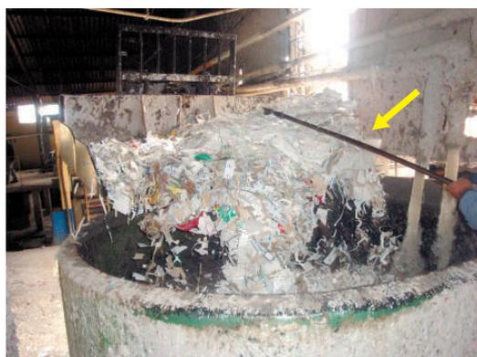
Alimentação com auxílio de um gancho de ferro para puxar o material que não sofreu queda no interior do equipamento por ação da gravidade.
